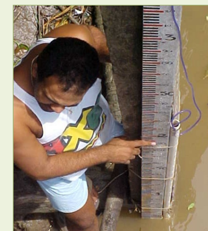
Figura 02-Explicação de leitura do nível de maré
