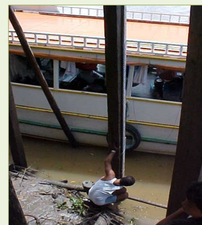
Figura 01 Instalação da régua de maré
